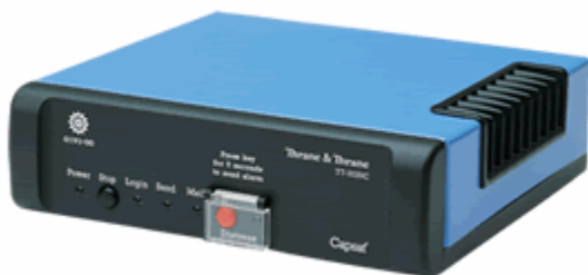
Figura 3 - Transceiver Inmarsat da Network Innovations – as unidades mais recentes suportam GPS e Inmarsat no mesmo corpo, ajudando à miniaturização.
